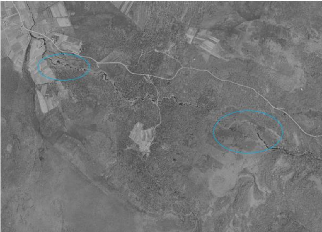
Kuva 14. Vanhimman ilmakuvasovitteessa v. 1947 muistelussa esille tulleet tulvapaikat, joissa tulvaa muisteltiin tapahtuneen. Nykyisen voimalinjan yläpuolella olevasta tulvapaikasta oli tietoa, että kyseisen alueen virtauksen suunnassa alapuolelle pakaantui jäitä ja ne nostattivat vettä.
