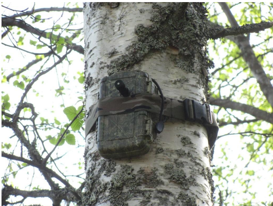
Kuva 28. Selvityksessä käytetty passiividetektori (Anabat Express).
